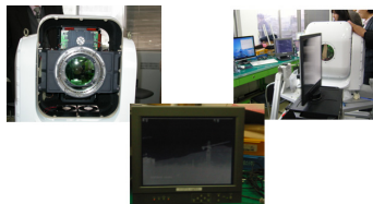
그림 8. 제작한 IRST와 획득한 LWIR 영상
