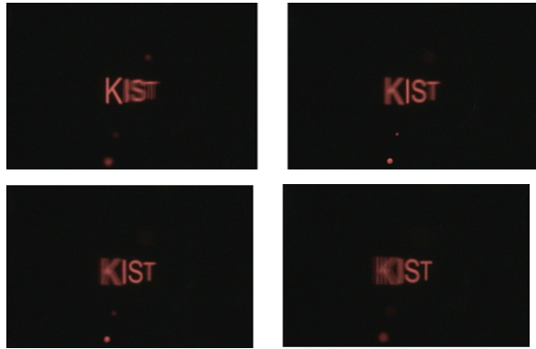
그림. 2 LED 광원 배열을 이용한 MF 시스템에서의 초점 조절 실험 결과
