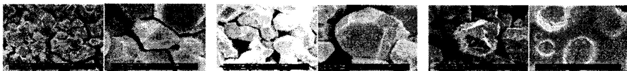
a) 8 μm b) 15 μm c) 23 μm 그림 4. 조사후 큰결정립 UO 2 소결체의 고온산화후 미세조직
