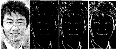
그림 4. threshold를 달리한 vertical Sobel mask를 적용한 이미지.
