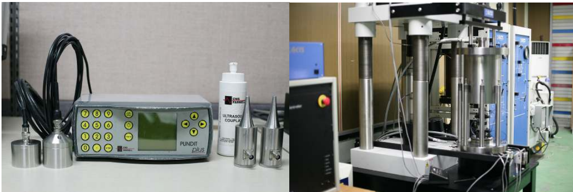
Fig. 1. 속도측정에 사용한 현장장비인 PUNDIT (left) 과 실내장비인 암삼축시험기 (right).
