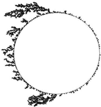
Fig. 7 d_p=0.05 \mu\text{m} 일 때 입자의 포집 형상
