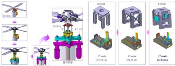
Fig. 6 피치제어 시스템 및 하부타워의 형상변경
