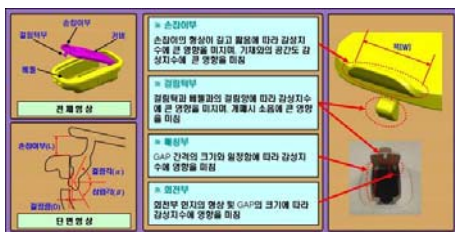
그림 2. 차일드 앵커 커버 형상 및 주요부
