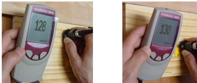
a) 목재 위 방염도료 도막두께 측정 b) 라벨 위 방염도료 도막두께 측정
