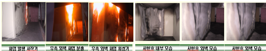
그림 3. ISO 13784-1 시험 결과 모습
