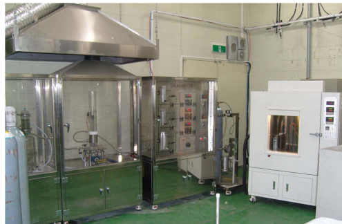
그림 1. 가스계 소화약제 실험 장치
