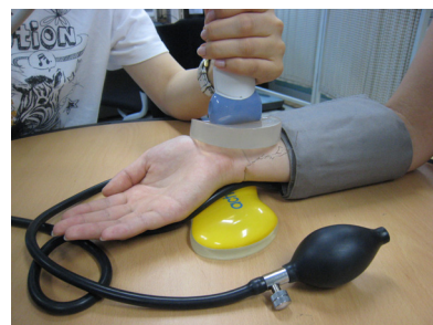
〈그림 2〉 커프를 이용한 가압 및 초음파 측정모습
