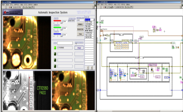
<그림 3.> 프론트 패널과 블록 다이어그램
