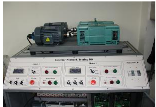
〈그림 6〉 Web기반 멀티모터 네트워크 제어 및 감시특성 실험 장치 전경
