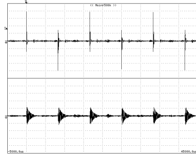
상 : 고역통과필터 출력[0.5V/div, 5ms/div] 하 : 대역통과필터 출력[0.5V/div, 5ms/div] (a) 정상상태
