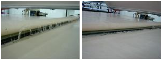
<그림 4> Gel 화에 따른 EVA Sheet의 변형 정도
