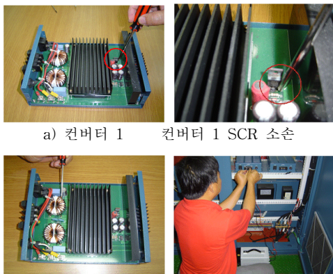
a) 컨버터 1 컨버터 1 SCR 소손 b) 컨버터 2 24V 전원 인가 시험 〈그림 6〉 DC/DC 컨버터 점검 시험
