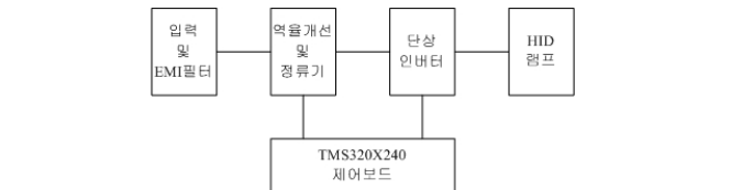
〈그림 3〉 제안된 전자식 안정기의 블록도
