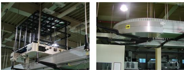
〈그림 6〉 OHS 실험장치 외관 (좌 - Vehicle, 우 - Track)
