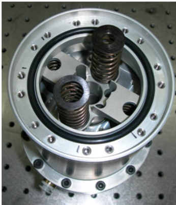
〈그림 4〉 공진구동형 선형액추에이터의 스프링과 내부형상
