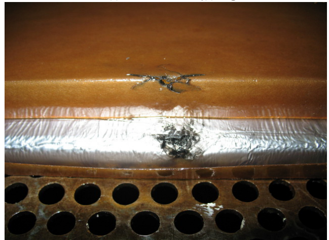
<그림 3> 고장이 발생한 소자와 Fuse가 용단되어 생성된 잔해
