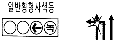
<그림 2> 횡형사색등 직·좌 동시등화 시 상충
