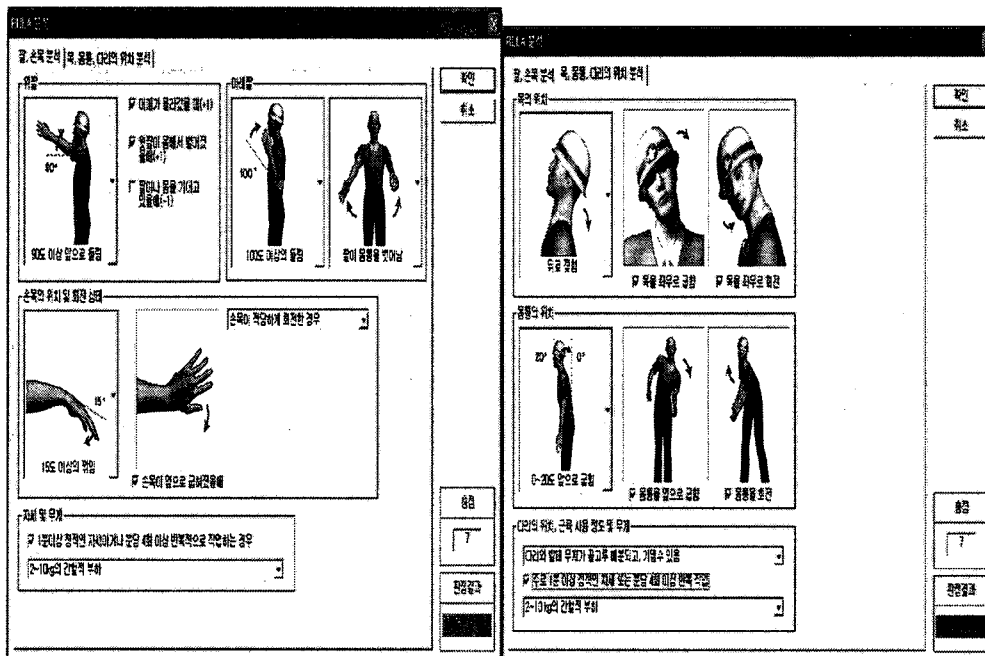
[그림 5] 건설작업 분석4: REBA분석
