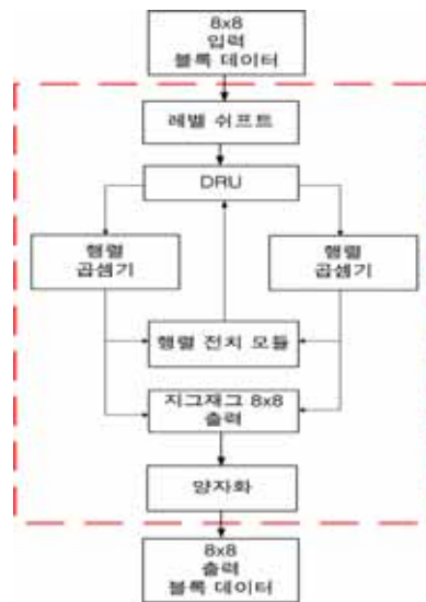
▶▶ 그림 1. 설계된 블록 다이어그램
