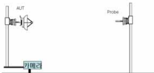
▶▶ 그림 1. 카메라 기반 근역장 측정 시스템
