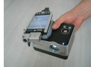
그림 4. PMP 2 에 사용된 PDA와 SDIO 타입의 모바일 카메라, 소형 프로젝터
