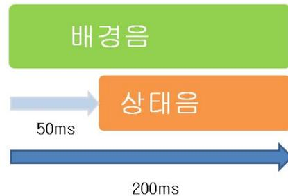
그림 5. 실험에 사용된 청각 디스플레이의 배경음과 상태음의 제시 형태. 기기의 종류를 알려주는 청각 아이콘이 배경음으로 제시되면서 그 위에 상태를 알려주는 이어콘이 50ms의 간격을 두고 겹쳐서 제시된다.
