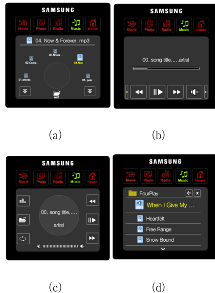
그림 9 전면 터치 UI (a) 기존 터치 스크린 방식 메뉴 배열 (b) TPP UI 방식의 메뉴 배열 (c) 기존 터치 스크린 방식 목록 배열 (d) TPP UI 방식의 방사형 메뉴 배열
