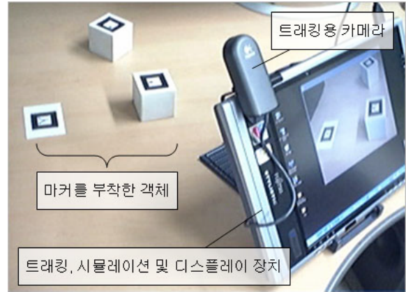
그림 4. 시스템 셋업. 시스템은 실제 환경을 트래킹하는 카메라와 트래킹을 위한 마커, 그리고 트래킹과 시뮬레이션을 수행하고 결과를 디스플레이 하는 장치로 구성된다. 마커는 증강현실에 참여할 실제 객체의 적당한 위치에 부착된다.
