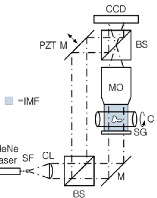
그림 1. 단층 촬영용 투과형 위상 이동 홀로그래피 현미경. SF, spatial filter; CL, colimating lens; BS, beam splitter; M, mirror; PZT M, piezo-translator attached mirror; SG, slide glass; C, capillary; MO, micro objective; IMF, index matching fluid.
