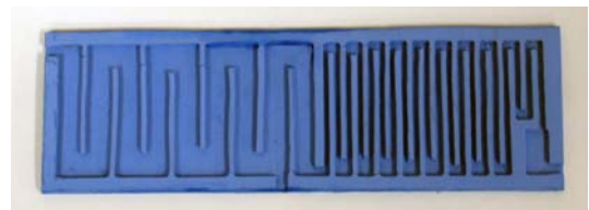
Fig 2. LTCC를 이용한 PROX 일체형 개질기
