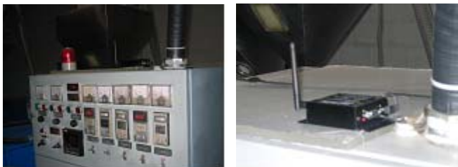
(a) 압출기 제어패널 (b) zigbee client module Fig. 5 생산현장의 설비에 설치된 Zigbee Module
