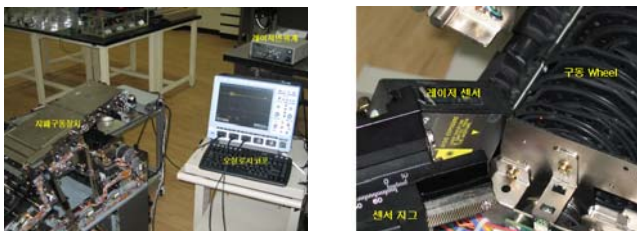
Fig. 8 Natural frequency test of stack wheel Impact 조건은 지폐구동장치 구동 Wheel 정지 시 하였으며 오실로스코프로 나온 시간/전압 데이터를 Matlab을 이용하여, FFT 분석 자료로 바꾸면 아래와 같은 결과 값이 나왔다.
