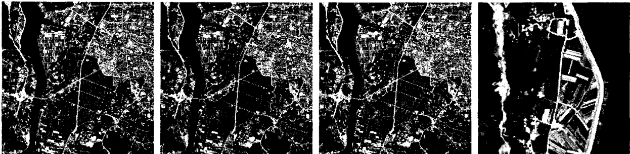
그림 4. RM에 의한 영상융합(좌측부터 nearest, ilinear, cubic 방법사용, 우측은 확대영상)
