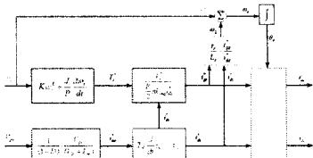
그림 5. 제시한 제어 시스템 블록도
