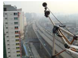
(a)도로교통소음 측정(W아파트) (b)도로교통소음 측정(M아파트)
