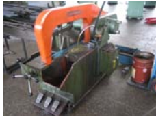
(h) 철재 가공톱(2.5kW)의 모습 및 파형
