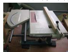
(e) 목재 전기톱(1.5kW)의 모습 및 파형
