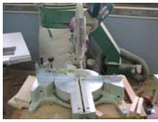
(g) 수직절단 전기톱(1.7kW)의 모습 및 파형
