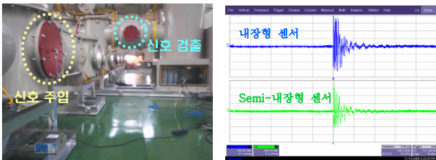
(a) 실험 현장 모습 (b) 측정 결과 〈그림 4〉 내장형 센서와 Semi-내장형 센서 특성 비교 실험
