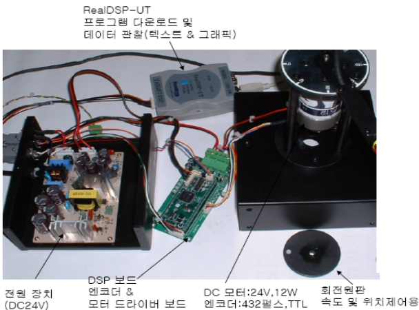
〈그림 5〉 eZdsp F2811 DSP 보드를 이용한 실험장치 구성
