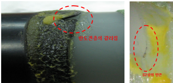
(B) 손상된 흔적이 발견된 반도체층 (C) 탄흔 흔적 〈그림 6〉 결함으로 추정된 단말 처리부
