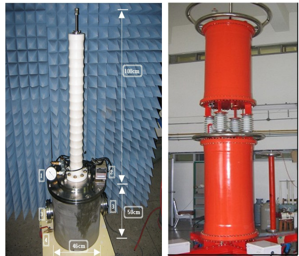
(a) 모의 GIS 챔버 (b) AC 전원장치 〈사진 1〉 실험용 모의 GIS 챔버, AC 300[kV] 전원장치
