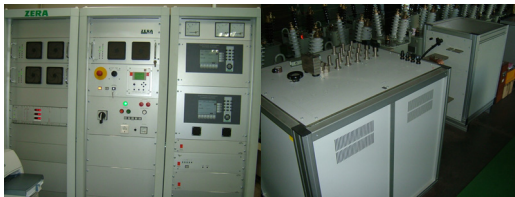
<그림 6 전자식 변성기 시험 시스템>
