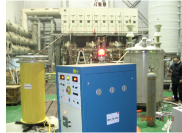
〈그림 6〉 AC 내전압 절연내력 실험 장면
