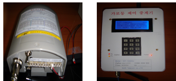
그림 4. 개발된 prototype 가로등 제어 단말기와 local 제어 센터
