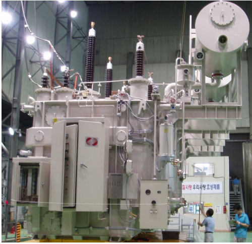
〈그림 4〉 Step-Lap 방식으로 제작된 154kV 변압기
