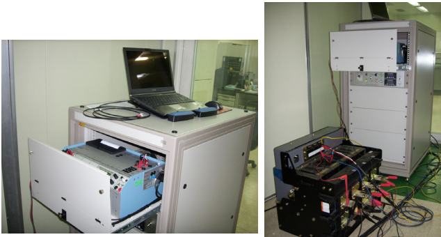
〈그림 1〉 동작특성 성능평가설비 및 내장된 전원공급장치
