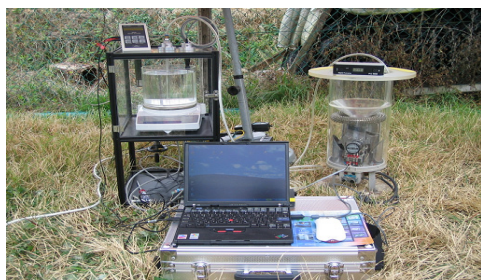
〈그림 1〉 전도형 우량계 현장교정용 표준교정시스템
