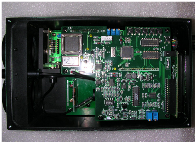
<그림 4> 구현한 고정밀 레이저 거리 측정기
