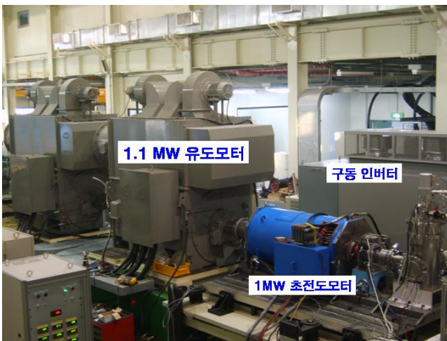
<그림 1> 1MW 급 고온초전도 모터의 부하 시험 장면
