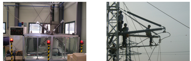
<그림 6> 절연암 성능 및 현장조립시험
